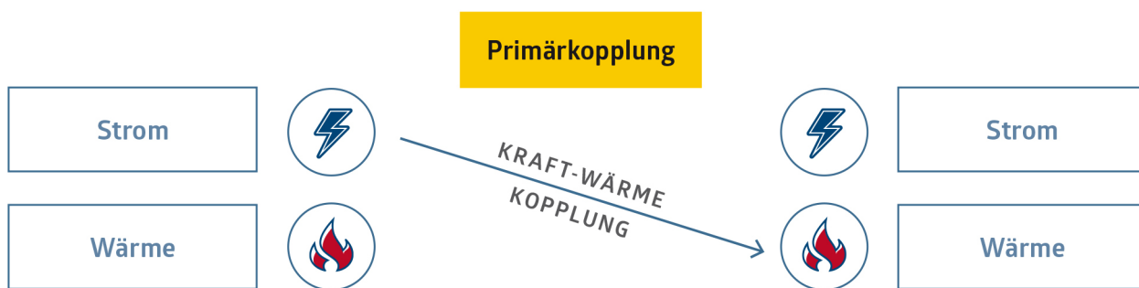
Abb. 9: Primärkopplung, Kraft-Wärme-Kopplung; eigene Darstellung
