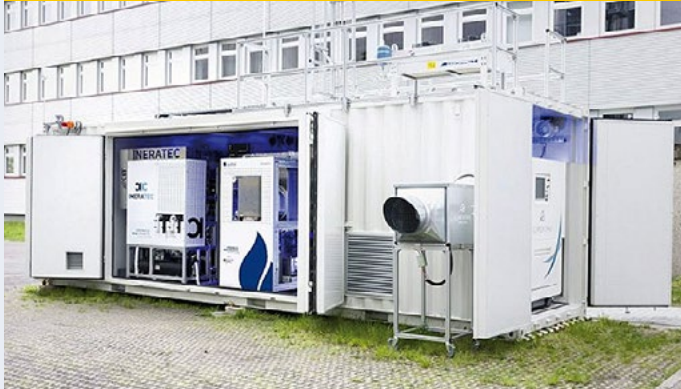
Abb. 23: Versuchsanlage zur Synthese von Kraftstoffen aus dem CO 2 der Luft; Langer 2019
